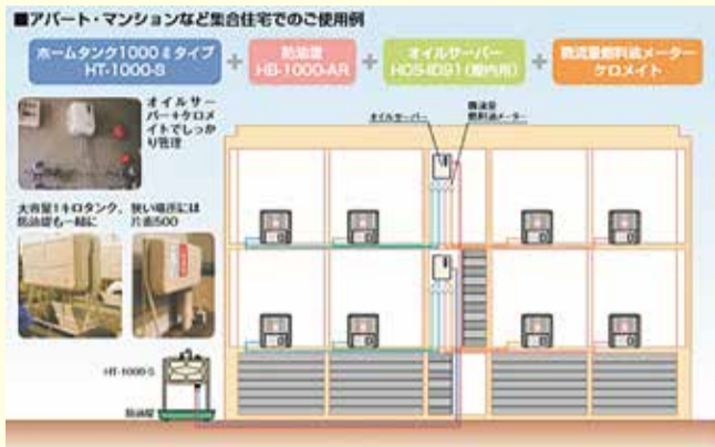
「集中タンク方式のアパート・マンション事例」
